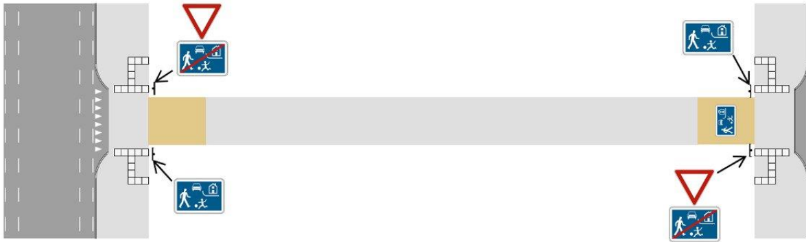
Schématisme d'une zone de rencontre avec surélévation par trottoir traversant en entrée, coloration et marquage du signal F12a
